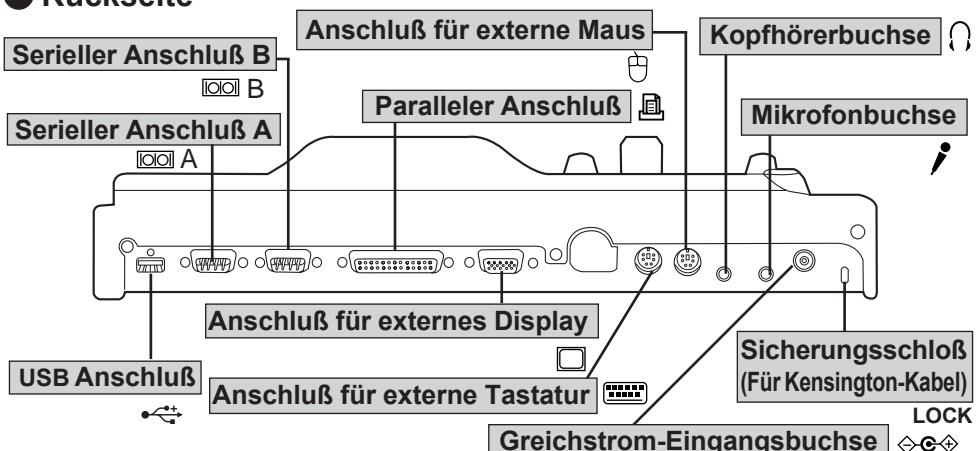
Hinweise zu den Funktionen der Anschlüsse und Buchsen finden Sie in der „Bedienungsanleitung“ (Namen und Funktionen der Komponenten usw.) oder dem „Reference Manual“ des Computers.
